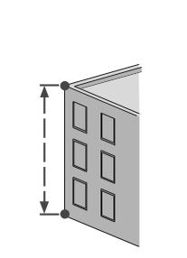
**i** Le résultat s'affiche sur la ligne principale et la distance mesurée au-dessus. Si on presse la touche de mesure pendant 2 s, la mesure minimum ou maximum est automatiquement activée.
