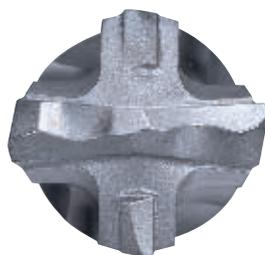
Tête de perçage à 4 taillants carbure et à géométrie symétrique 4 x 90° qui perce même à travers les armatures métalliques du béton armé
