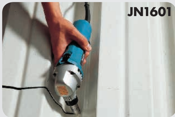
Pour tôles ondulées et bacs en acier
