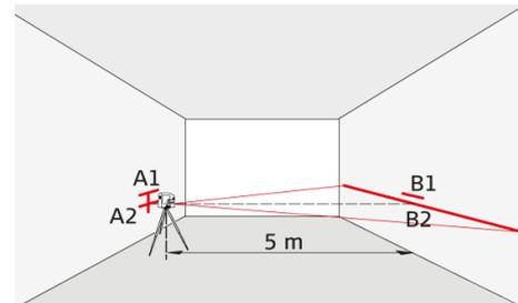
Placer ensuite l'instrument à la même hauteur le plus près possible du mur A et marquer encore une fois la ligne laser horizontale ou le point laser sur le mur A (A2). Tourner l'instrument de 180° et marquer la projection laser sur le mur B (B2). Mesurer les distances des points marqués A1-A2 et B1-B2. Calculer la différence des deux mesures.
