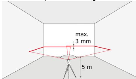
Régler l'interrupteur de verrouillage dans la position déverrouillée (voir [Verrouillage du calage](#)). Placer l'instrument à env. 5 m du mur. Pointer l'instrument sur le mur et le mettre sous tension. Activer la ligne laser et marquer le point d'intersection du réticule laser sur le mur. Pivoter l'instrument à droite, puis à gauche. Noter l'écart vertical entre la ligne horizontale et le repère. Si la différence ne dépasse pas 3 mm, l'instrument se trouve dans la plage de tolérance.
