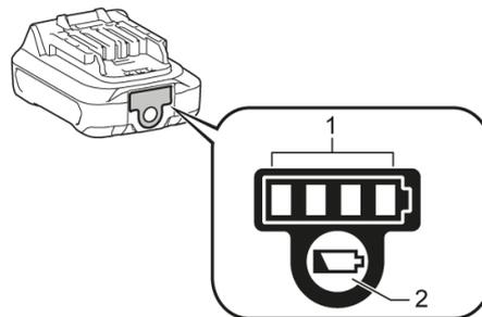
Appuyez sur le bouton de vérification (2) sur la batterie pour indiquer la charge restante de la batterie. Les témoins (1) s'allument pendant quelques secondes.
