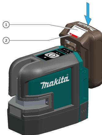
Pour retirer la batterie, faites-la glisser hors de l'outil tout en faisant glisser le bouton à l'avant de la batterie.
