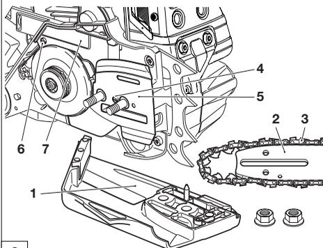
Enlever la protection de roue à chaîne (1) (voir chapitre „MISE EN ROUTE“ B) nettoyer l'intérieur à l'aide d'un pinceau.
