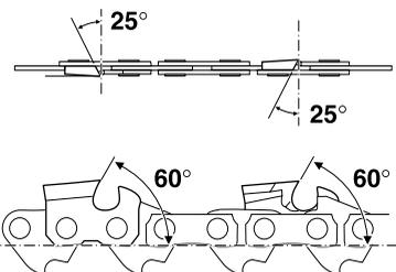
L'angle d'affûtage 25° doit être identique pour toutes les dents de rabotage. Des angles différents provoquent une marche irrégulière et rude de la chaîne, augmentent l'usure et aboutissent à des ruptures de chaîne!
