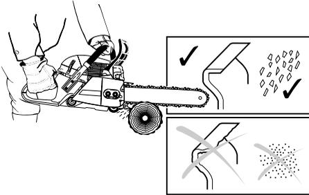
**ATTENTION:** Pour tous travaux effectués sur le guide de la chaîne de sciage, le moteur doit être impérativement arrêté et la fiche de bougie doit être enlevée (voir paragraphe pour le remplacement de la bougie) et le port de gants de protection est obligatoire!
