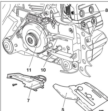
Nettoyer la plaque de guidage (5) et nettoyer le couvercle du dispositif de freinage (7).
