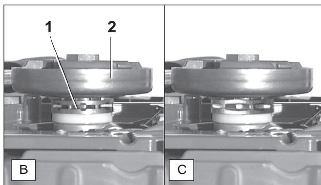
Avant de monter une nouvelle chaîne de sciage, il faut vérifier l'état de la roue à chaîne (B/1).
