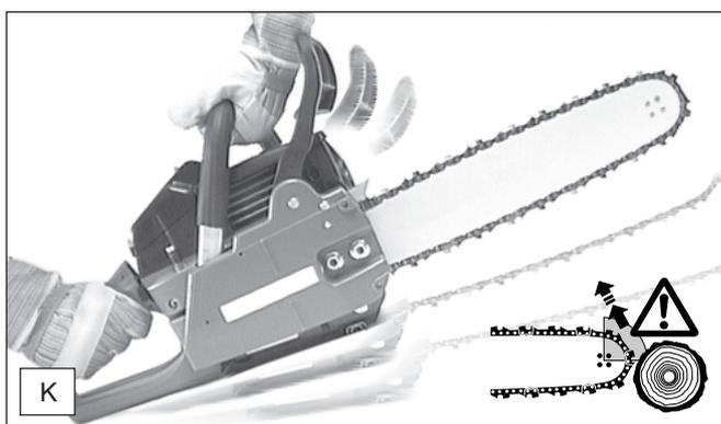
Les modèles DOLMAR sont équipés en série d'un frein de chaîne à déclenchement d'accélération. Si un contrecoup se produit (kickback), dû à un heurt de la pointe du guide contre le bois (voir chapitre « CONSIGNES DE SECURITE » à la page 6), le frein de chaîne se déclenche automatiquement en cas de contrecoup suffisamment fort par inertie de masse. La chaîne de sciage est interrompue pendant une fraction de seconde.
