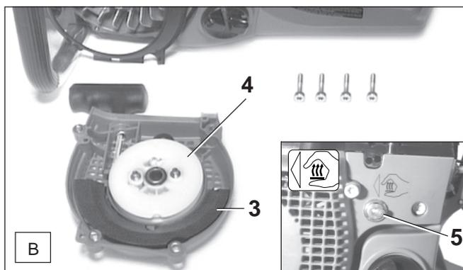
Pour atteindre la température de service plus vite (mesure réduisant l'usure et la consommation), un insert (B/3) peut être introduit dans le carter du ventilateur (B/4).
