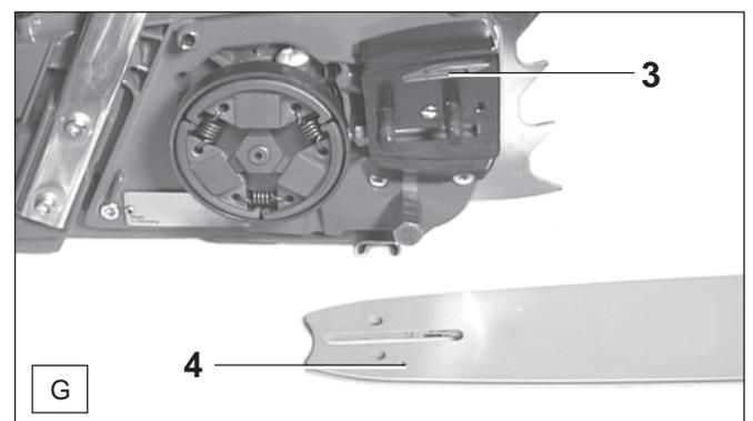
Pour que la pompe à huile fonctionne toujours parfaitement, la rainure de guidage d'huile sur le carter du vilebrequin (G/3), ainsi que les orifices d'entrée d'huile dans le guide de la chaîne (G/4) doivent régulièrement être nettoyés.
