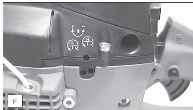
**Le réglage du carburateur sert à garantir un fonctionnement optimal, une consommation économique et une sécurité d'utilisation sans compromis. Il doit être effectué quand le moteur est chaud, le filtre à air propre et la chaîne de sciage correctement tendue. Recourir à un atelier spécialisé DOLMAR pour le réglage du carburateur.**
