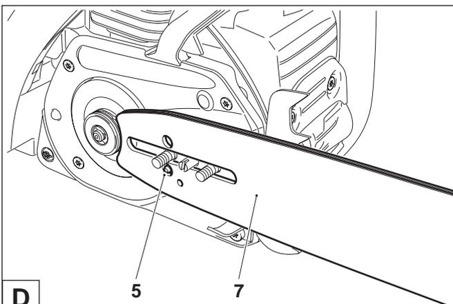
Poser le guide (7). S'assurer que le tenon (5) du tendeur de chaîne s'engrène dans le trou de la chaîne de sciage.
