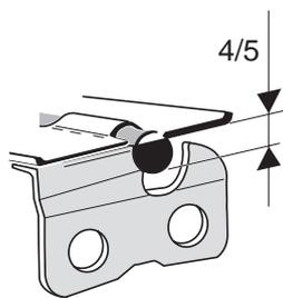
Un porte-lime facilite le guidage de la lame, il porte des repères pour l'angle d'affûtage correct de:
