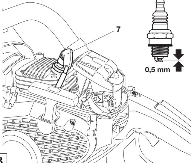
En cas de détérioration du corps isolant, d'usure importante des électrodes resp. d'électrodes très encrassées ou pleines d'huile, il faut procéder à un remplacement de la bougie.
