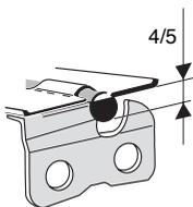
Un porte-lime facilite le guidage de la lime, il porte des repères pour l'angle d'affûtage correct de:
