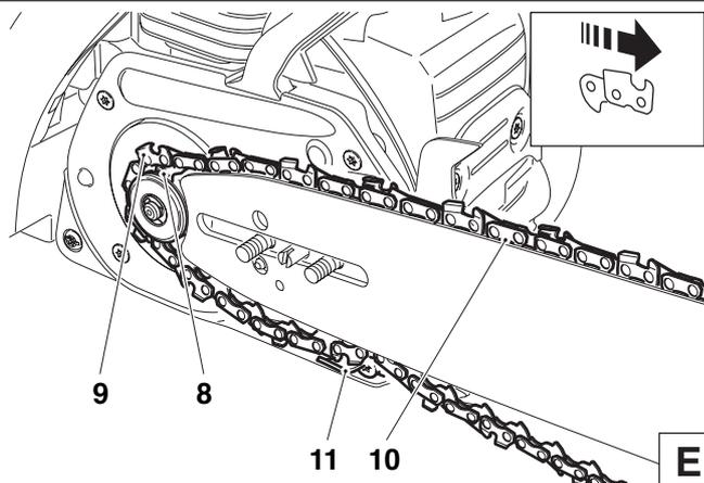
Guider la chaîne de sciage (9) autour de l'étoile de renvoi (12) du guide de la chaîne, en tirant légèrement la chaîne de sciage dans le sens de la flèche.
