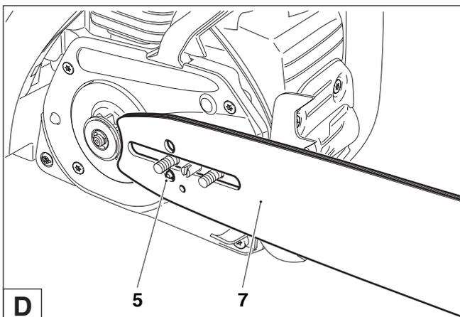
Poser le guide (7). S'assurer que le tenon (5) du tendeur de chaîne s'engrène dans le trou de la chaîne de sciage.
