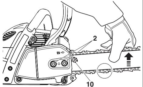
**Contrôle de la tension de la chaîne**
