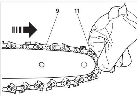
Guider la chaîne de sciage (9) autour de l'étoile de renvoi (11) du guide de la chaîne, en tirant légèrement la chaîne de sciage dans le sens de la flèche.
