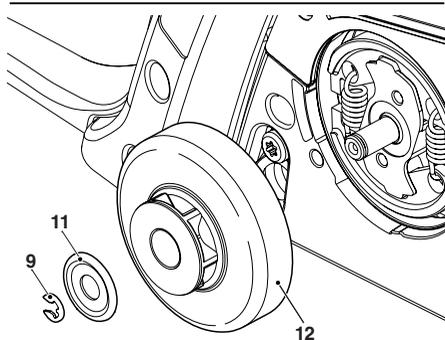
Avant de monter une nouvelle chaîne de sciage, il faut vérifier l'état de la roue à chaîne.
