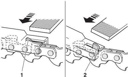
A la suite du nouvel affûtage, vérifier la hauteur du limiteur de profondeur avec la jauge de mesure pour chaîne.
