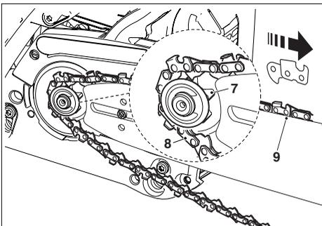
Guider la chaîne de sciage (8) autour de l'étoile de renvoi (10) du guide de la chaîne, en tirant légèrement la chaîne de sciage dans le sens de la flèche.
