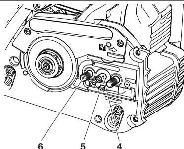
Poser le guide (7). S'assurer que le tenon (5) du tendeur de chaîne s'engrène dans le trou de la chaîne de sciage.
