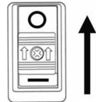
Remarque: Si le moteur ne s'arrête pas dans la position "○", tirez le "BOUTON DE L'ENRICHISSEUR" pour l'arrêter. Si la chaîne continue à tourner après que vous avez tiré le bouton de l'enrichisseur, lorsque le moteur est en fonctionnement, faites immédiatement réviser la scie à chaîne auprès d'un distributeur agréé.
