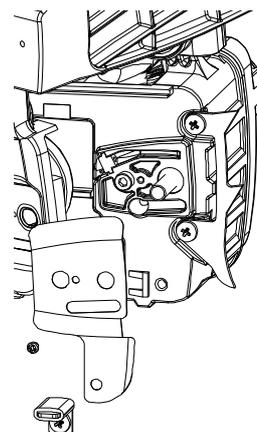
5. Fixez le guide-chaîne avec la vis correspondante (M3) et la vis de la griffe d'abattage (M5).
