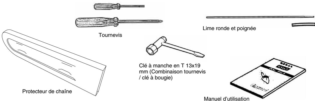
**Protecteur de chaîne** : Dispositif amovible couvrant le guide-chaîne et la chaîne durant le transport et le remisage de la scie.
