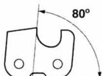
Angle d'attaque du plateau de la gouge
