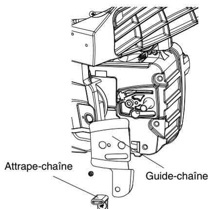
4. Vissez la griffe d'abattage sur le carter du moteur avec 2 vis et serrez-les à 300~400Ncm (31~41kgf-cm).
