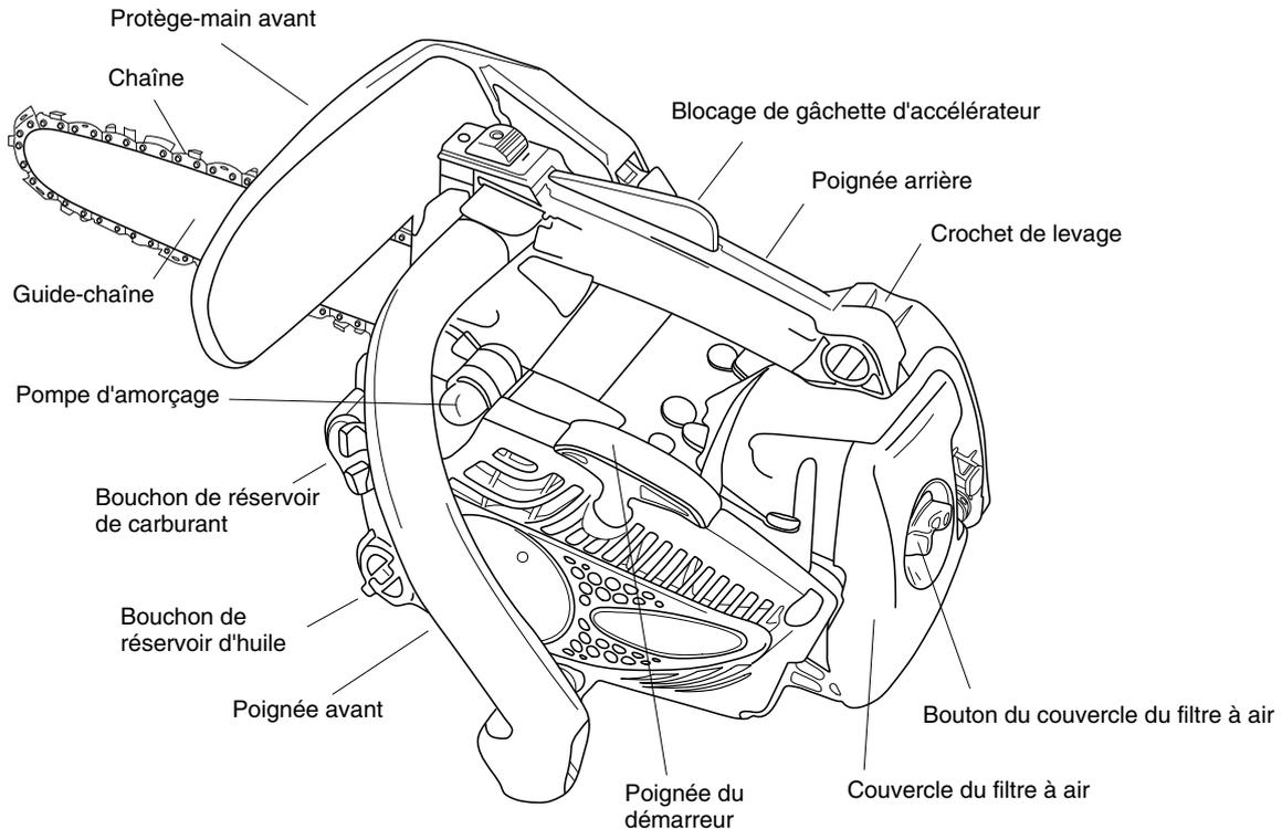
**Protège-main avant** : Dispositif situé entre la poignée avant et la chaîne pour protéger la main et réduire le risque que la main ne se blesse à la chaîne en cas de perte de prise de la scie. Cette protection est utilisée pour activer le frein de la chaîne, afin d'arrêter sa rotation.
