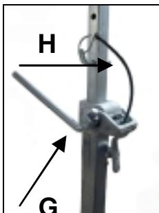
Anbring borestationen. Anbring fastspændingsanordningen så tæt så muligt bag stangen på borestationen. Fastgør stationen ved at skrue kranken (G) med uret. Stationen sikres med dertil hørende bolte (H).
