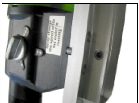
Zum Lieferumfang gehört eine Montageplatte, eine Passfeder 10 mm und 4 Innensechskantschrauben M8 x 20. Die Montageplatte wird mit der Passfeder so auf die Maschine aufgesetzt, dass sich die Buchse in der Montageplatte auf der gleichen Seite befindet wie die Getriebeumschaltung der Maschine. Danach werden die vier Schrauben eingesetzt und fest angezogen.
