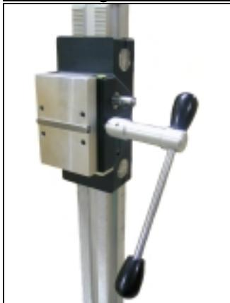
Plaats de montageplaat met de kernboormachine in de hoogste positie tot deze vergrendeld.
