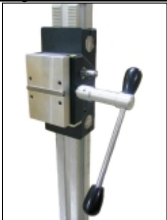
Fahren Sie den Maschinenhalter mit dem Kernbohrgerät so weit nach oben, bis dieser in der Endlage einrastet.
