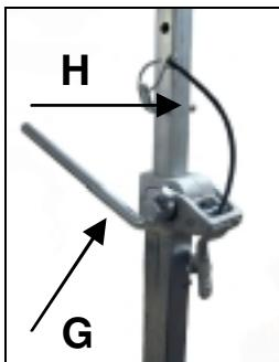
Plaats de voetplaat. Plaats de stempel zo dicht mogelijk bij de kolom van de voetplaat. Zet de stempel vast door de hefboom (G) met de klok mee te draaien. Vergrendel de installatie met de bijbehorende pal (H).
