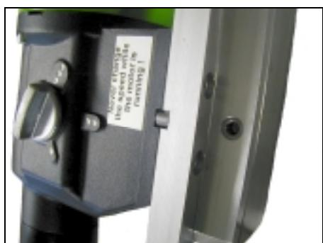
La herramienta se suministra con una placa de montaje, una llave de ajuste de 10 mm y 4 tornillos de cabeza hueca hexagonal M8x20. La placa de montaje se fija en la herramienta con la llave de ajuste de forma que el acoplamiento en la placa de montaje quede en el mismo lado que el cambio de marchas del motor. Luego se colocan y se aprietan los 4 pernos.
