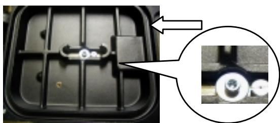
Sichern Sie den Vakuumgriff mit Hilfe der Unterlegscheibe und Innensechskantschraube M8x30 und setzen Sie die Fußdichtung in die dafür vorgesehene Aussparung ein.
