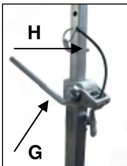
Coloque o suporte de perfuração na posição adequada. Coloque o suporte com fecho de abertura rápida o mais perto possível atrás do suporte na base do suporte. Fixe o suporte, rodando a manivela (G) no sentido dos ponteiros do relógio. Fixe a instalação nessa posição usando a cavilha adequada (H).
