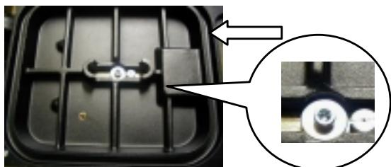
Zet het vacuüm handvat vast met een sluitring en een 6-kant imbusbout M8x30, en plaats de afdichtingsstrip in de uitsparing.
