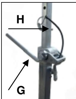
Coloque el soporte del taladro. Sitúe el puntal lo más cerca posible por detrás del soporte en la base. Fije el soporte girando el eje (G) en el sentido de las agujas del reloj. Fije la posición con el perno apropiado (H).
