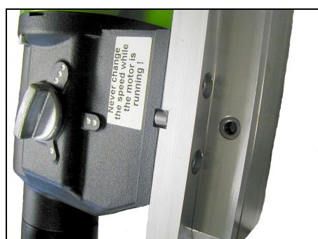
Le support de carotteuse P-54190 est livré avec une plaque de maintien, une clé plate de 10mm et 4 vis M8. La plaque de maintien se fixe sur l'outil à l'aide la clé de telle manière à ce que l'accouplement soit du même côté que du sélecteur de vitesse.Puis visser les 4 vis.
