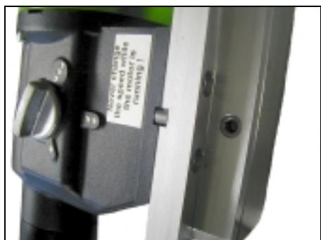
A ferramenta é fornecida com uma placa de montagem, uma chave de fixação de 10 mm e 4 parafusos fêmea hexagonais M8x20. A placa de montagem é fixa à ferramenta com a chave de fixação, de modo a permitir que o acoplamento na placa de montagem seja feito do mesmo lado em que se muda as velocidades do motor. Depois, introduzem-se e apertam-se bem os quatro parafusos.
