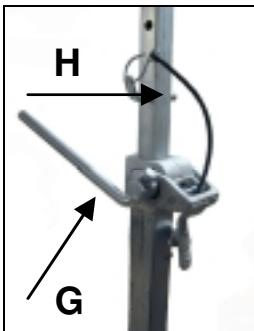
Positionieren Sie den Bohrständer. Setzen Sie die Schnellspannsäule so dicht wie möglich hinter der Säule auf dem Ständerfuß auf. Fixieren Sie den Bohrständer durch Drehen der Kurbel (G) in Uhrzeigersinn. Sichern Sie die Einstellung mit dem dazugehörigen Bolzen (H).
