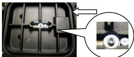
Aperte a pega de vácuo usando a anilha e o parafuso fêmea hexagonal M8x30 e insira o vedante no furo correspondente.
