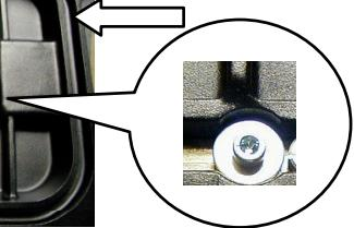
Fixer la poignée de l'aspirateur avec une rondelle et une vis tête hexagonale M8x30 et insérer le joint dans l'encoche correspondante .
