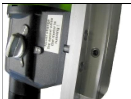
Med borestationen P-54190 følger en monteringsplade, en 10 mm nøgle og 4 skruer M8 x 20. Monteringspladen fastgøres på værkøjjet med nøglen, således at sammenføjningen på monteringspladen sidder på samme side som motorens gearsatifte. De 4 skruer monteres.
