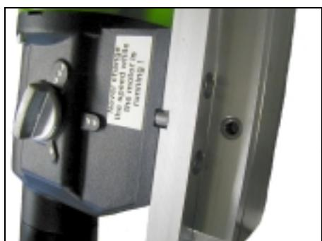
L'intelaiatura P-54190 è provvista di piastra di montaggio, di una chiavetta di 10mm, di 4 viti esagonali M8. La piastra di montaggio è fissata sulla carotatrice tramite la chiavetta in modo tale che il giunto sulla piastra di montaggio sia rivolto dalla stessa parte della leva cambio del motore. Il tutto è fissato dalle 4 viti.
