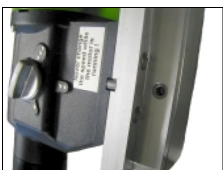
De boorstandaard P-54190 wordt geleverd met een montageplaat, een 10 mm passpie en 4 inbusbouten M8. De montageplaat wordt zodanig op de machine geplaatst met de passpie dat verbinding op de montage plaat aan dezelfde zijde zit als de toerenregeling van de motor. Daarna worden de 4 inbusbouten geplaatst en vast gezet.
