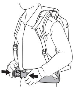
**APRECAUÇÃO:** Certifique-se de que solta a fivela do cinto de quadril antes de descarregar o soprador.
