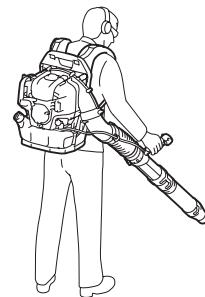
1. Üfleme makinesini kullanırken gaz düğmesini / gaz kolunu, rüzgar gücü çalışılan yer ve şartlara uygun olacak şekilde ayarlayın.
