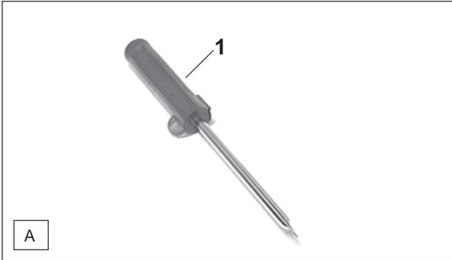
Réglage du régime de ralenti avec un tournevis (lame de 4 mm).
